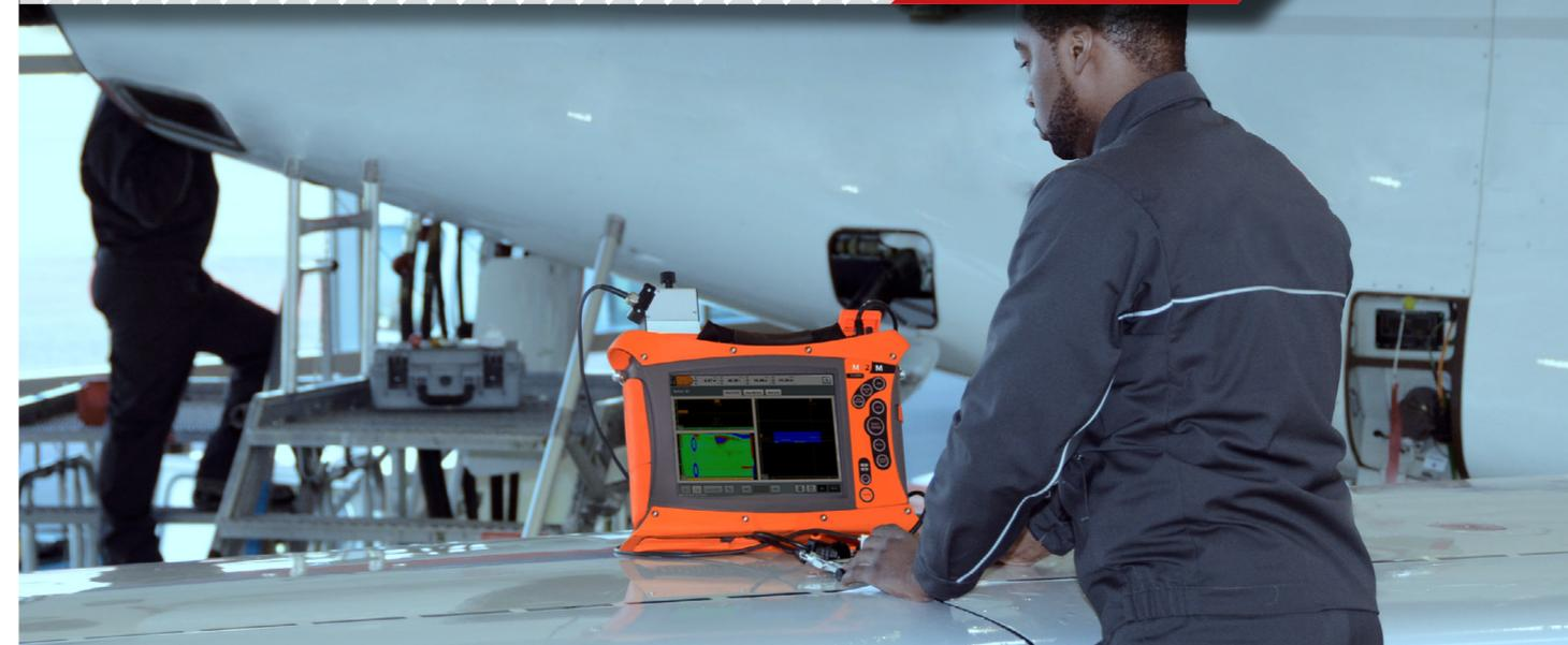
↘ Le contrôle par ultrasons (ultrasonic testing en anglais), symbole UT, l'une des méthodes d'essais non destructifs les plus utilisées, se base sur l'analyse d'une onde ultrasonore s'étant propagée dans la pièce inspectée.
