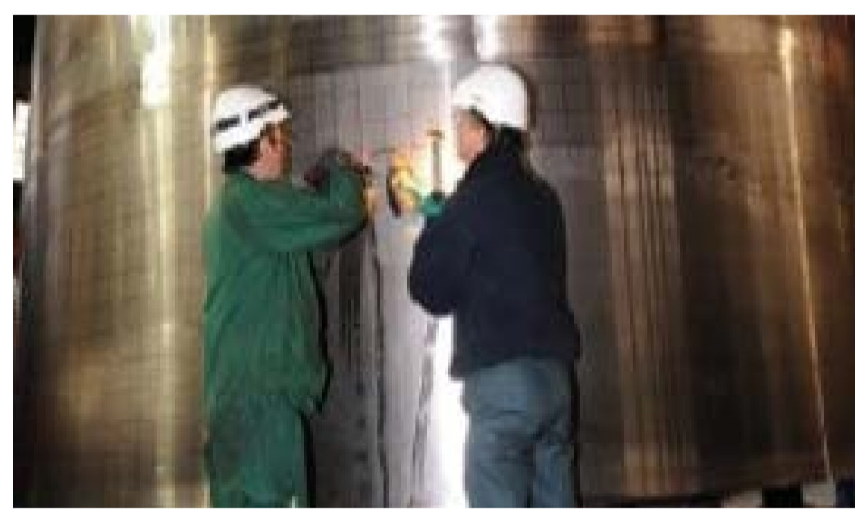
Contrôle de viroles par magnétoscopie (Crédit photo : AREVA)
