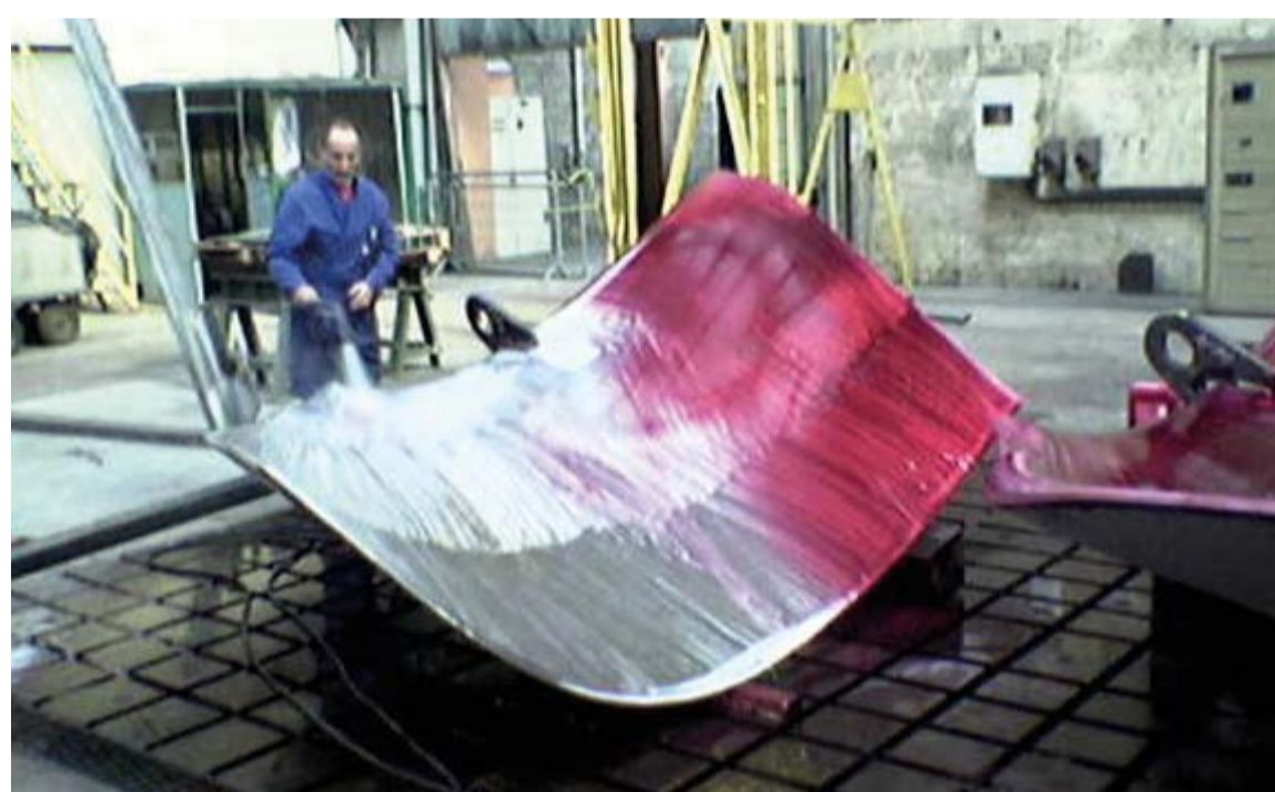
Rinçage en atelier (crédit photo BABB CO Socomore NDT Division)
